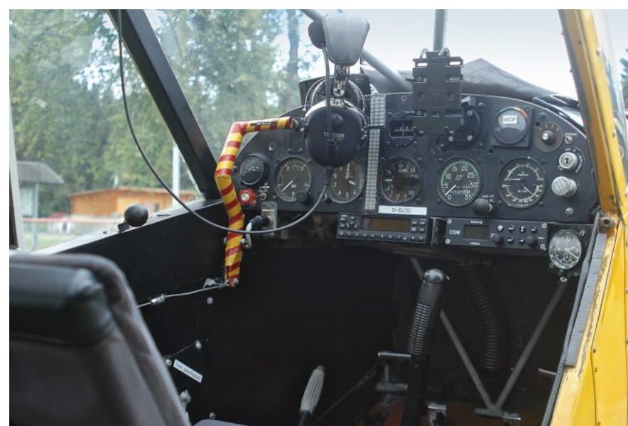
Das Cockpit einer Cub ist immer puristisch. Der rot-gelbe Hebel dient zum Ausklinken des Seglerschleppseils. Cub bedeutet Bärchen.
